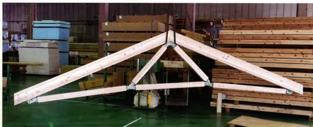
P3 金物工法の開発実験—カナダツガとの相性は抜群
