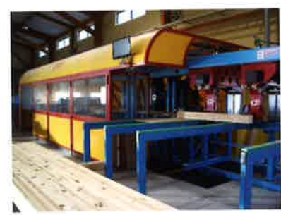
ダイテックの工場で150mm角材を製材する様子。大断面専用の製材機械を使用する。写真=ダイテック
