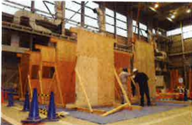
試験体で使う全ての材の重さを量り、密度を算出した。カナダツガの一部にスギに近い密度の材が含まれていた (写真: 左も耐震研究会)
