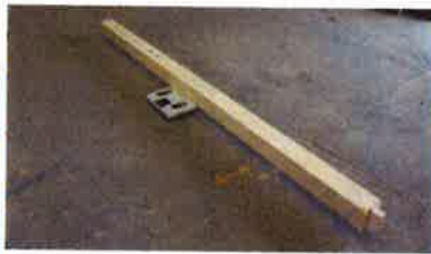
試験体で使う全ての材の重さを量り、密度を算出した。カナダツガの一部にスギに近い密度の材が含まれていた (写真: 左も耐震研究会)
