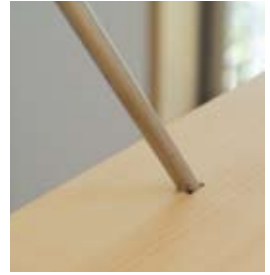
框と組子が同寸法の吉村障子 (左) CDラックのブレース貫通 箇所。天板を割いてブレースを つけてまた張り合わせている。 継ぎ目が見えない (下)
